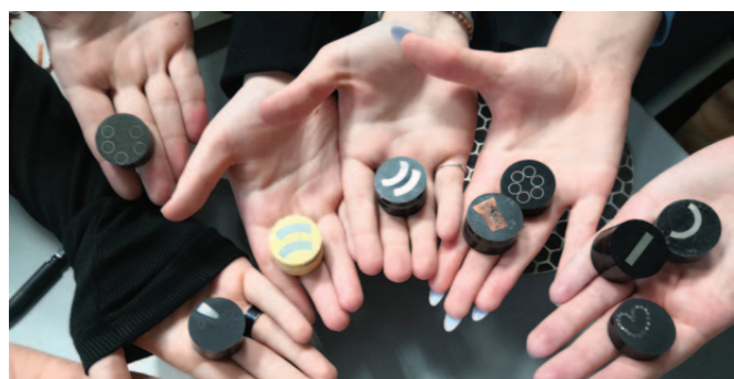
МОНЕТЫ, ЦЕПОЧКИ, БОЛТИКИ: В ХОД ПОШЛИ ВСЕ МЕТАЛЛИЧЕСКИЕ ПРЕДМЕТЫ, КОТОРЫЕ МОЖНО БЫЛО ЗАПЕЧИТЬ В ПОЛИМЕРНУЮ МАТРИЦУ С ПОМОЩЬЮ ВЫСОКОТЕМПЕРАТУРНОГО ПРЕССОВАНИЯ.
